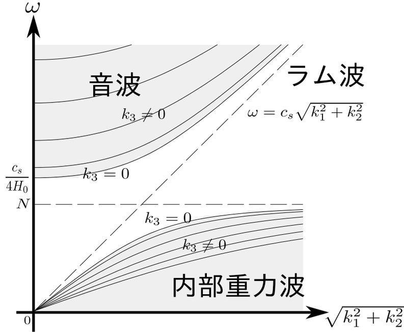
図 3: 成層のある場合：音波, 内部重力波の分散関係.
