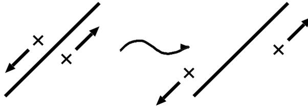
図 1: 静止流体に接線方向の応力が存在する場合.
