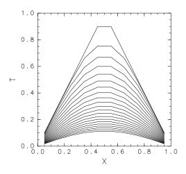
図 2: 1 次元拡散方程式の計算結果. t=2.0 までの結果を t=0.1 間隔で示した.
