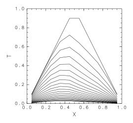
図 3: 1 次元拡散方程式の計算結果. x>0 で K=3.0 とした場合. その他は図 2 と同じ.
